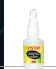
Adesivo monocomponente incolore ad alta viscosità, particolarmente indicato per l'incollaggio di materiali porosi o posti in posizione verticale. Viene impiegato nell'industria per l'incollaggio di materiali assorbenti quali cuoio, sughero, legno, porcellana. Incolla perfettamente superfici con tolleranze fino a 0,25 mm.
